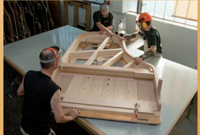
Maximale Verwendung von Fichtenresonanzholz – hier bei der Raste und Spiellade
