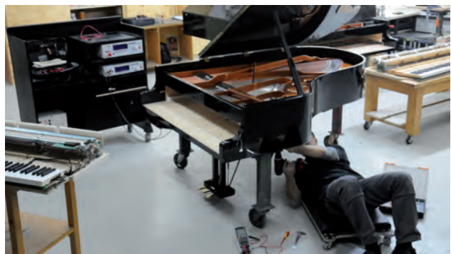
Die Bösendorfer disklavier™ E3 Selbstspieleinrichtung kann auch nachträglich eingebaut werden.
