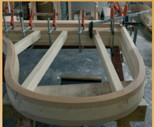
Bei einem echten Bösendorfer wird die Raste aus Fichtenresonanzholz und Rotbuche gefertigt.
