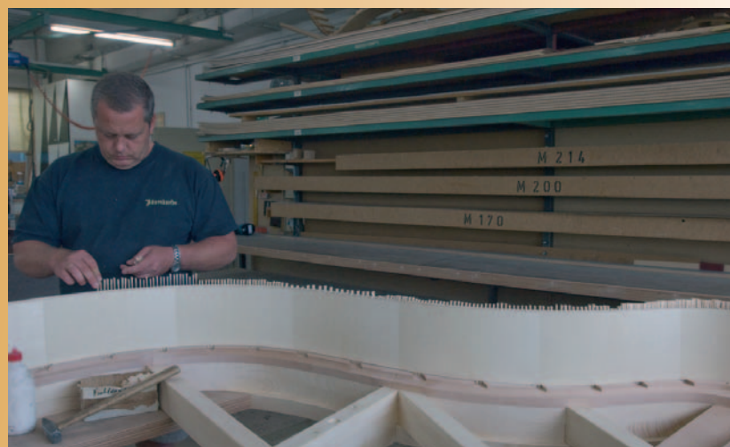
Um die Einschnitte wieder auszufüllen, werden Fichtenholzkeile an der Oberseite der Kastenwand eingebracht.
