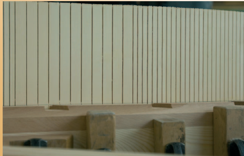
Bei der Herstellung der Krümmung der Kastenwand wird durch gezielte Einschnitte die Biegung des Massivholzes ermöglicht.
